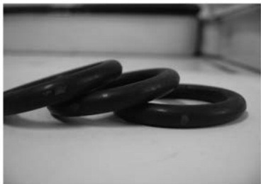
图 12 氢化丁腈橡胶 \Phi 25\text{ mm}\times 6\text{ mm} O 形密封圈 90 °C 老化试验结束后
