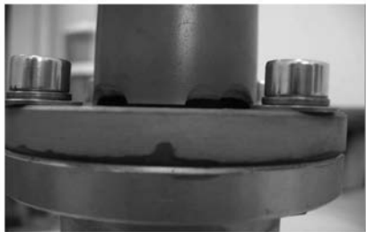
图 9 泄露试验工装包覆电极实拍照片
