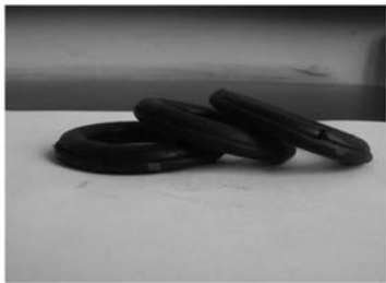
图 10 丁腈橡胶 \Phi 25\text{ mm}\times 6\text{ mm} O 形密封圈 50 °C 老化到 102 d
