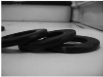
图 11 丁腈橡胶 \Phi 25\text{ mm}\times 6\text{ mm} O 形密封圈 90 °C 老化试验结束后
