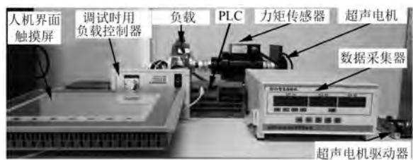
图 2 测试系统硬件总体连接图
