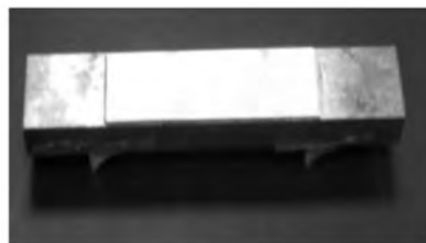
图 6 驻波型直线超声波电机样机
