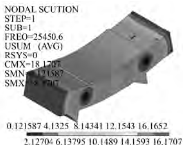
图 3 电机横向一阶弯曲振动的振型
