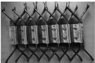
图 8 风力发电机定子模型线圈
