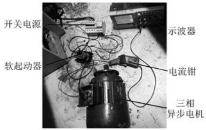
图 16 异步电机软起动器试验平台图
