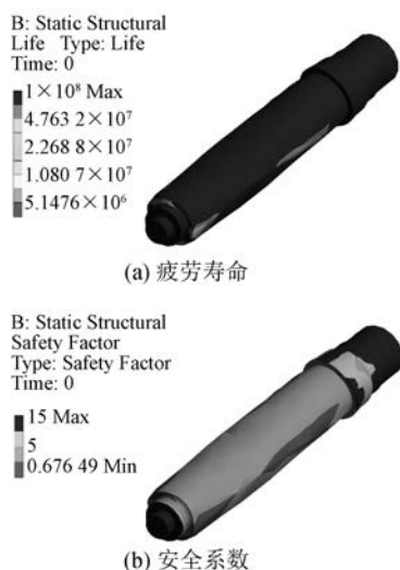
图 14 2\text{E}+09 倍负载时采用凹圆角的转轴的疲劳特性
