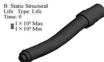
图11 60 000 r/min 负载时转轴的疲劳寿命
