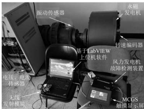
图 3 直驱风力发电机故障检测试验台
