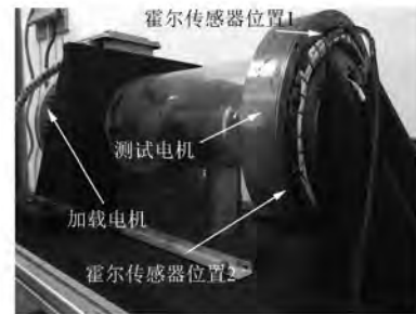
图 4 试验台架及霍尔位置传感器的安装位置
