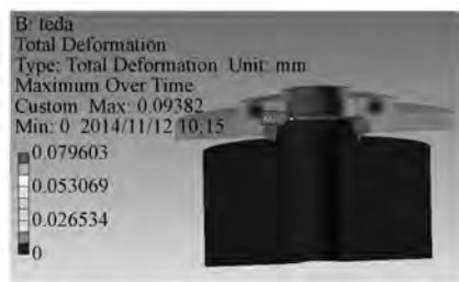
图 7 大垫圈压缩后变形量仿真
