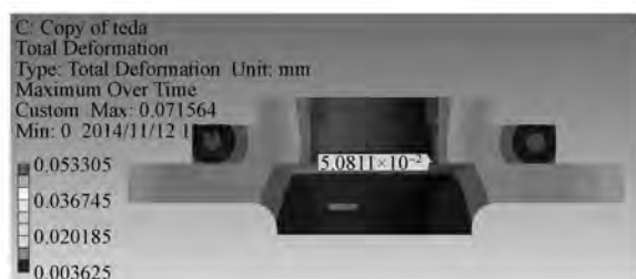
图 8 采用大垫圈和锥形弹簧垫圈压缩后变形量仿真
