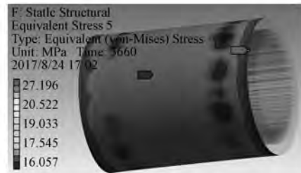
图 12 过盈配合面热应力云图
