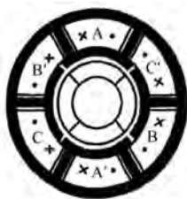
图 1 三相四极永磁容错电机结构
