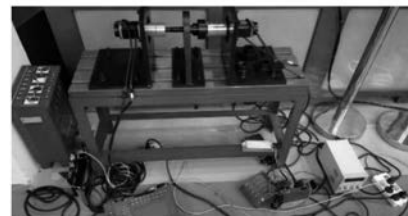
图 5 刚性伺服试验平台
