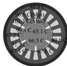
图 17 电机稳态径向截面温度
