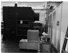
图 12 电机的温升试验测试平台
