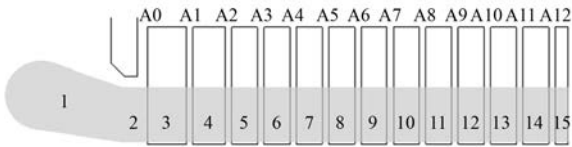
图 5 定子各径向风道位置编号及定子绕组线圈温度取样点位置编号示意图
