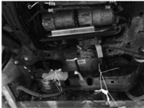
图 4 电机在整车中的布置位置
