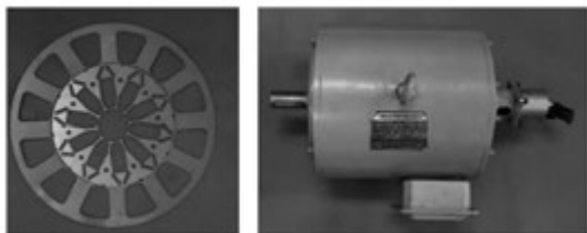
图11 电机的硅钢片和样机
