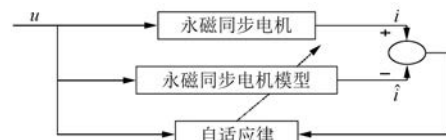
图2 模型参考自适应辨识系统
