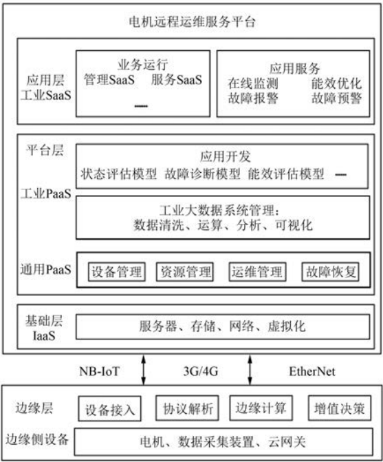
图 2 基于云平台的电机远程运维系统架构图
