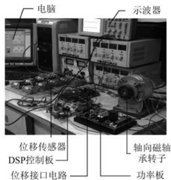
图6 轴向磁轴承试验平台
