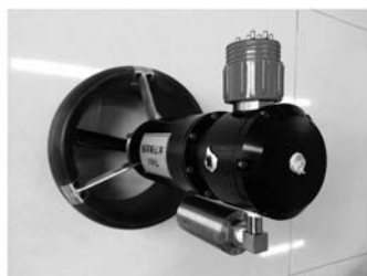
图5 高速 ROV 辅推推进器
