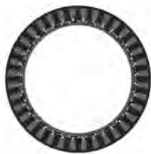
图 2 36 槽 42 极永磁电机模型
