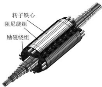
图2 3 MW 无刷同步发电机转子模型
