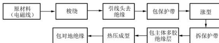
图3 传统线圈热压工艺一流程
