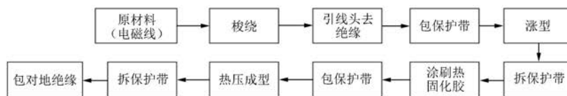
图4 传统线圈热压工艺二流程
