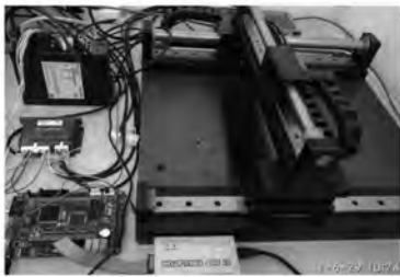
图3 直线电机XY伺服平台的实物图
