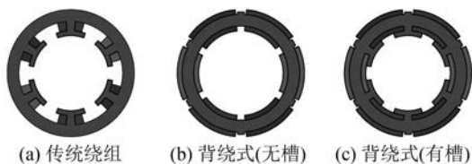
图 1 传统绕组结构和背绕式结构示意图
