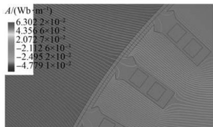
图 11 额定负载磁力线分布
