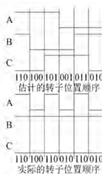
图 8 抖动堵转判断原理图
