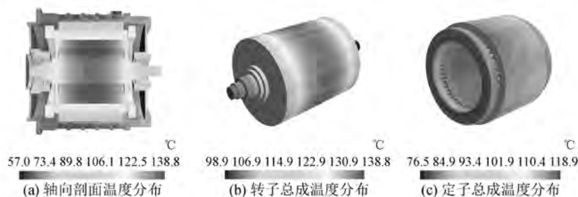
图5 高速爬坡工况匀速行驶时的温度分布
