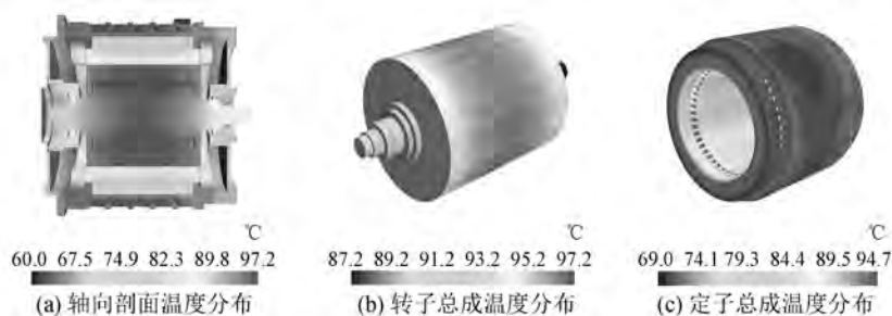
图4 低速爬坡工况匀速行驶时的温度分布
