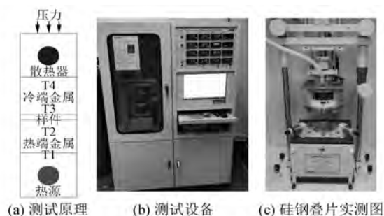
图3 硅钢叠片轴向导热系数测试
