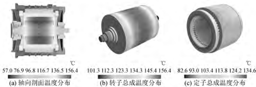
图6 超高速平路工况匀速行驶时的温度分布
