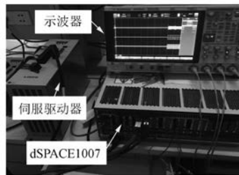
图 7 基于 dSPACE 的试验平台
