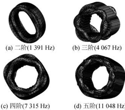
图6 带有绕组的定子铁心各阶模态及对应频率
