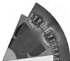
图8 阻尼绕组开路、励磁绕组超导体短路时磁力线分布情况
