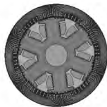
图 6 A 相通电产生的 d 轴磁场
