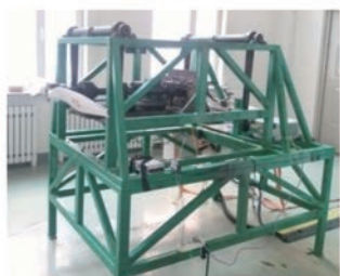
图 11 地面模拟飞机飞行台架试验台
