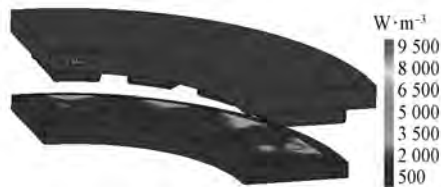
图4 SL-DTPM 电机涡流损耗密度云图
