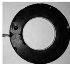
图 7 SL-DTPM 电机线圈灌胶实物图
