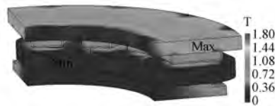
图 2 SL-DTPM 电机磁密云图
