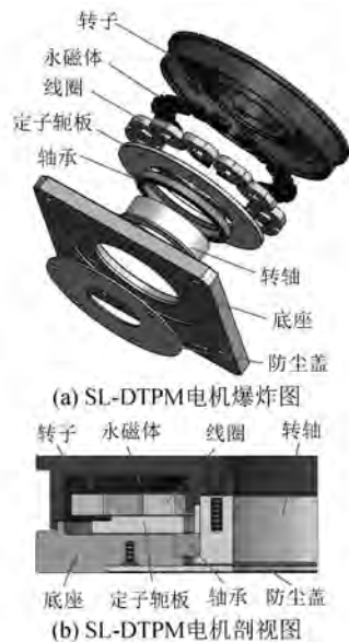
图 1 SL-DTPM 电机结构
