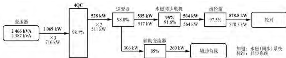
图2 再生制动工况部件功率计算
