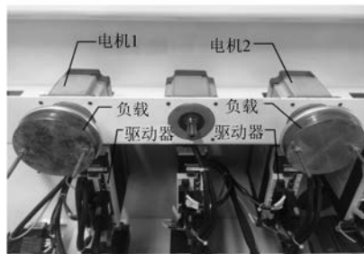
图2 双电机同步控制试验平台
