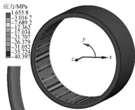
图2 碳纤维护套径向应力云图
