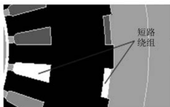
图8 电机17匝短路故障模型
