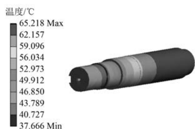
图8 屏蔽电机转轴温度分布云图
