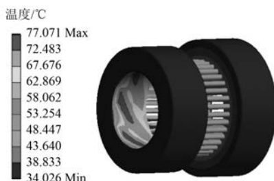
图7 屏蔽电机环氧树脂温度分布云图
