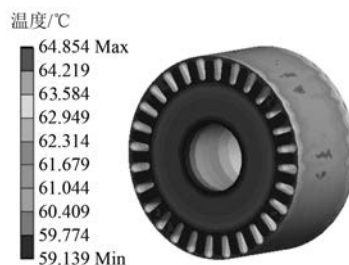
图4 屏蔽电机转子温度分布云图
