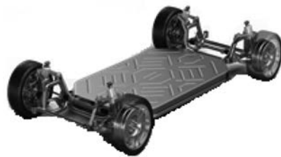
图 8 PD18 轮毂电机在新底盘平台搭载示意图
