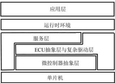
图 12 碳化硅控制器软件架构示意图
