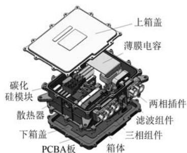
图 2 碳化硅控制器结构布置爆炸图
