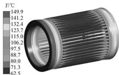
图 7 传统型电机绕组温度分布图
