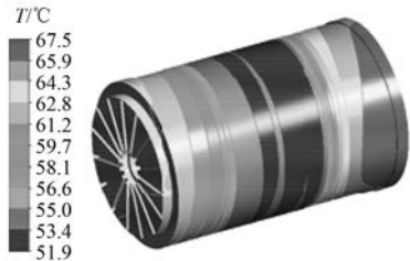
图 12 尾部热管微曲型电机机壳与端盖温度分布图
