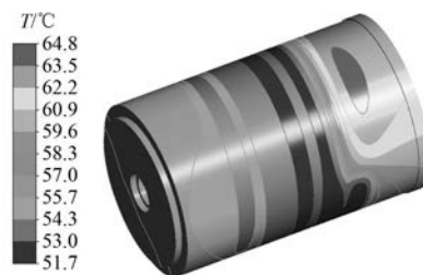
图 9 传统电机机壳与端盖温度分布图
