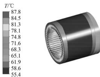
图 11 尾部热管微曲型电机定子铁心温度分布图
