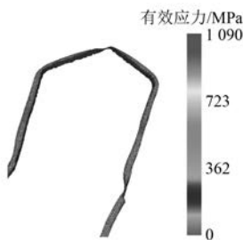
图7 线圈成型仿真图( \mu_k=0.3, v=18 \text{ mm/s} )
