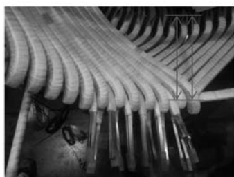
图15 定子嵌线端部效果图
