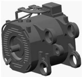
图 1 EMU 永磁电机三维外形
