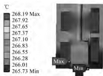
图 8 “线圈分段+段间导热环”的温度分布
