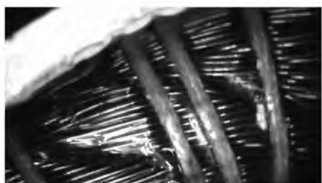
图4 某型号定子 E-UV 沉浸后端部线包放大图
