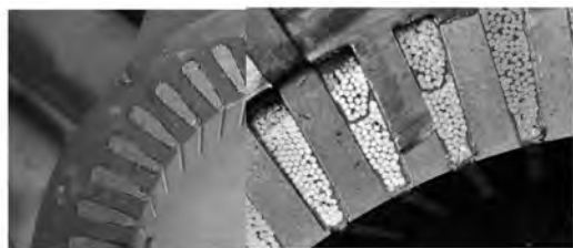
图3 某型号定子浸漆后剖切图
