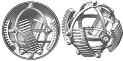
图 12 新型无输出轴多自由度球形感应电机
