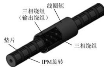
图 2 内置式永磁二自由度电机
