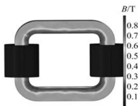
图6 中频变压器铁心磁密分布图
