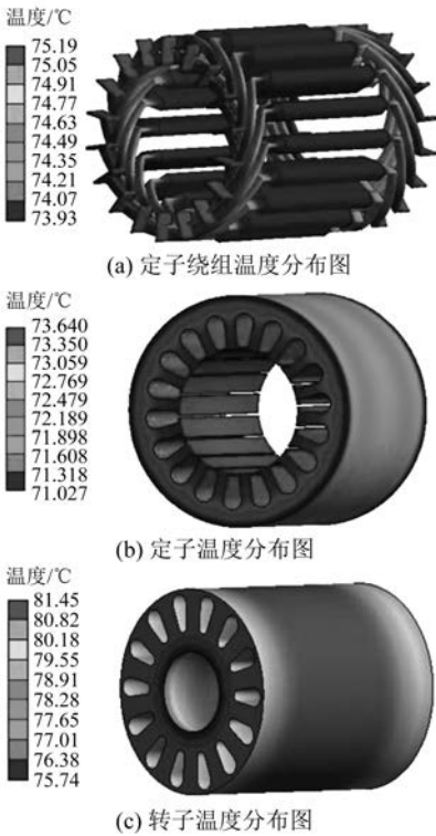
图 7 异步电机温度分布图
