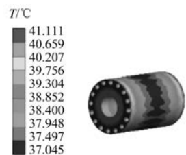
图 9 转子铁心温度分布
